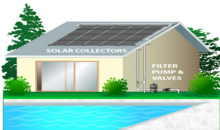
شکل ۱- شماتیک تاسیسات یک استخر خورشیدی
