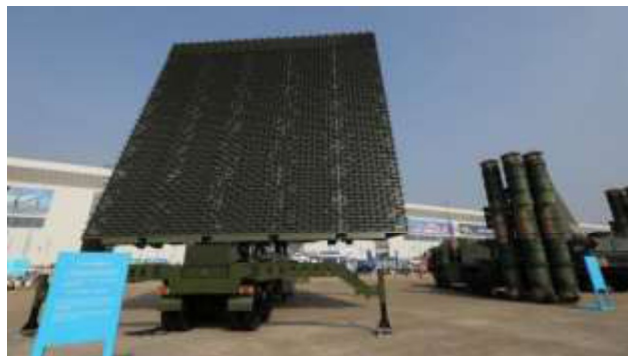
شکل ۱ سامانه راداری جمع آوری اطلاعات الکترونیکی
