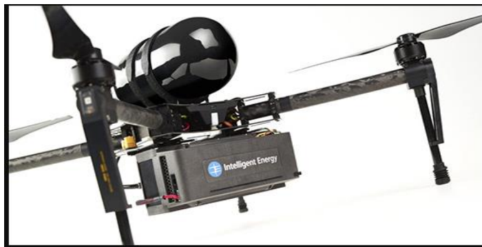
شکل ۲- نمونه‌ای از پهپاد با پیل‌های هیدروژنی
